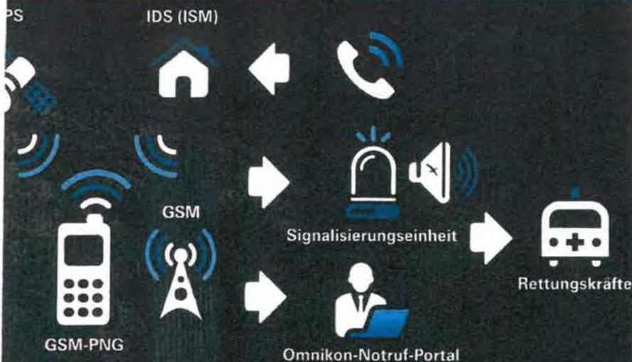
Im Alarmfall wird ein Signal an eine Signalisierungseinheit gesendet, die einen optischen und akustischen Alarm auslöst. Gleichzeitig werden Daten per GSM/GPRS an den Omnikon-Notrufzentralrechner gesendet.
