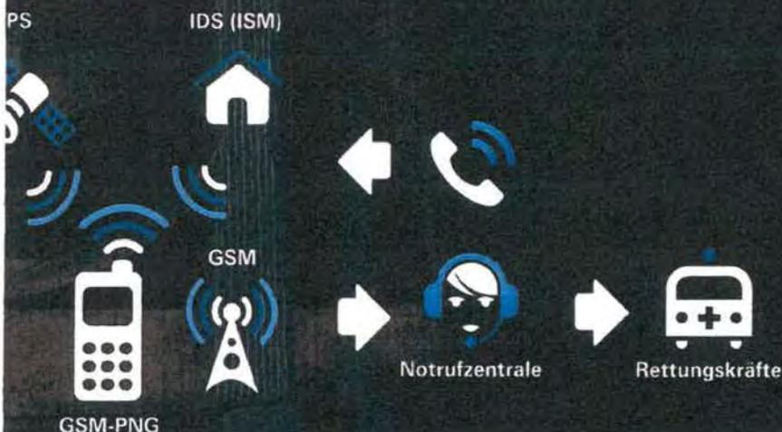
Im Alarmfall erfolgt eine Meldung per GSM/GPRS an die rund um die Uhr besetzte Sicherheitszentrale. Diese veranlasst gemäß vorgeschriebenem 4-Stufen-Maßnahmeplan alle notwendigen Schritte.
