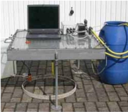
Bild 1: Mit einem Tropfinfiltrometer kann die Wasserdurchlässigkeit eines Belages geprüft werden
